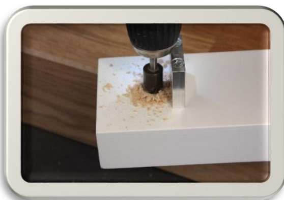
och försänk så att skruven inte kan ta i överliggaren
