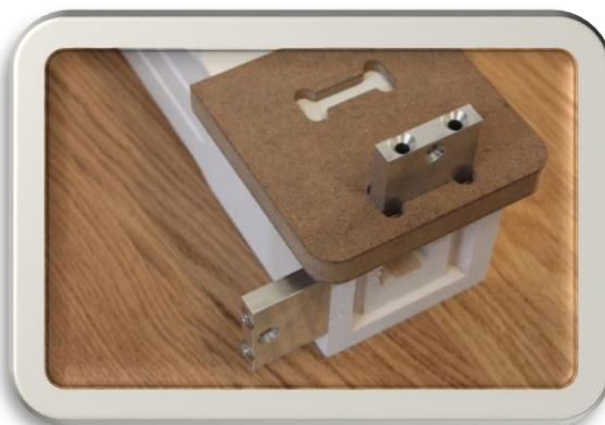
Nederkant stolpe. 5x50 skruv ( förborra 3,5 )
