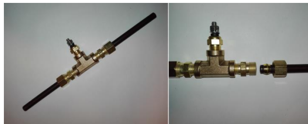
Figur 15: Montering av temperaturgivare till automatlådeoljan med hjälp av T-koppling samt klämringsskoppling för 5/16" rör
