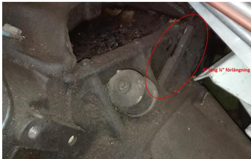
Figur 4: 4" lång förlängning för att montera oljetrycksgivare på passagerarsidans hål
