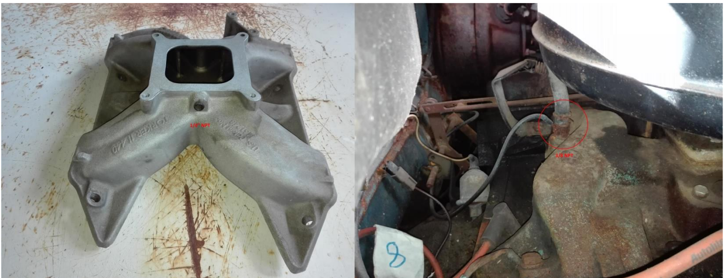
Figur 12: Edelbrock Torker II eftermarknadsinsug samt originalinsug till 361
