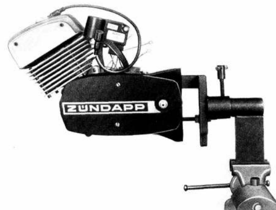
Motor mit Super-Therm-Zylinder in der Haltevorrichtung SK-A 314
