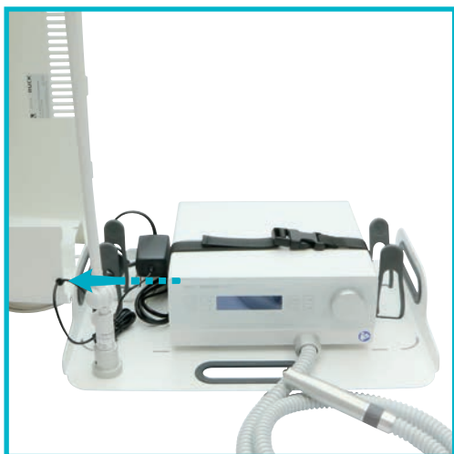
11. SCHWARZE KABELDURCHFÜHRUNG IN VORDERE AUSSPARUNG DER TECHNIKHAUBE EINSETZEN.
