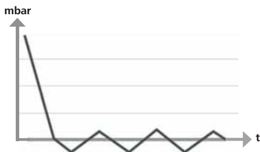
Схема двухпозиционного регулирования вакуума
