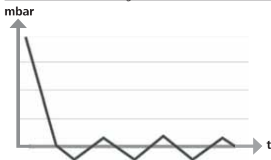
Schematische Darstellung einer Zwei-Punkt-Vakuumregelung
