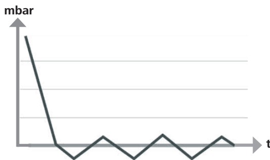
Representación esquemática de una regulación de dos puntos del vacío
