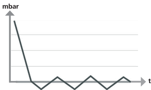
Illustration schématique d'une régulation du vide à deux points
