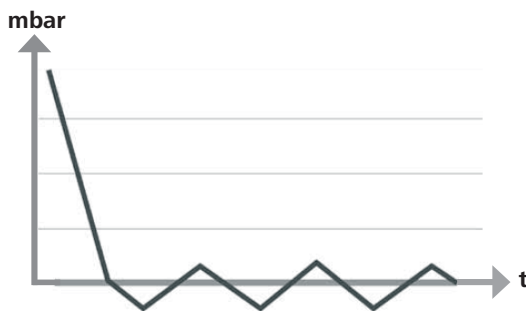
Tampilan skema kontrol vacuum dua posisi
