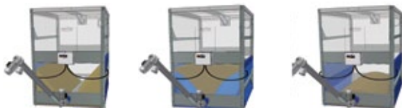
1. Ca 800 kg pellets återstår. Utmatarskruven blir tom.
