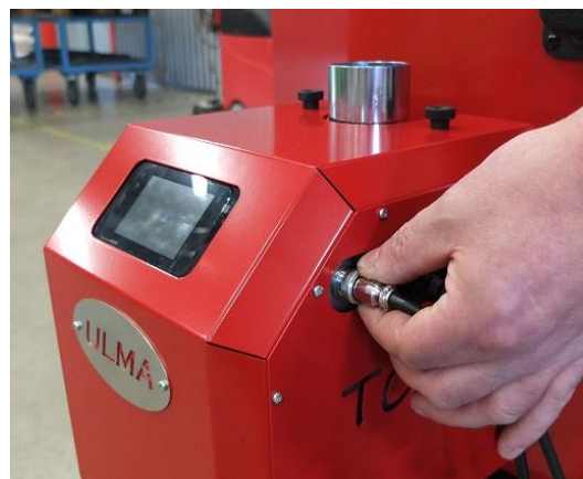
2. Skruva ut låsringen innan du drar ut tempgivarkontakten.
