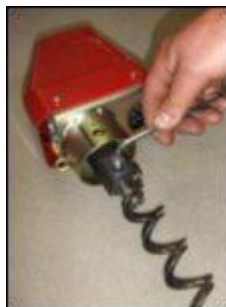
9. Drag åt den yttre fästskruven.
