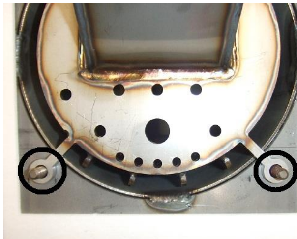
10. O.B.S ! När det inre brännarröret återmonteras måste båda styrtapparna hamna i hålen på brännarröret.
