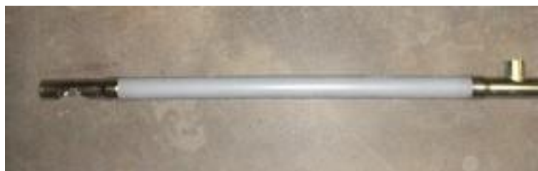
15. Skruvrör och T-rör sammankopplade.
