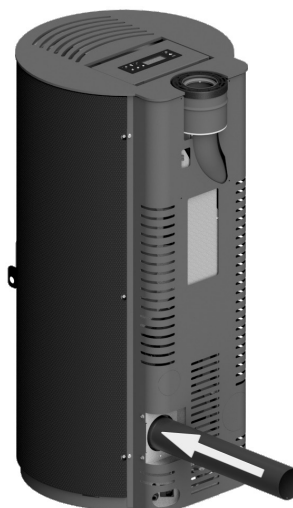
Fig. 32 - Koppla in slangen
