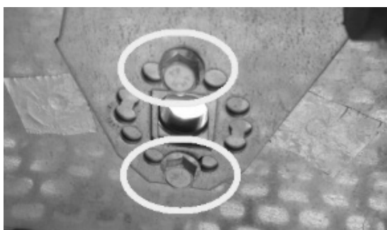
Fig. 60 - Borttagning av skruvar
