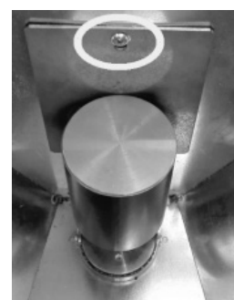
Fig. 61 - Borttagning av skruv
