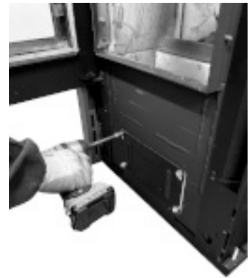
Fig. 42 - Ta bort inspektionslocket
