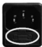
Fig. 59 - Lucka med säkringar som ska tas bort
