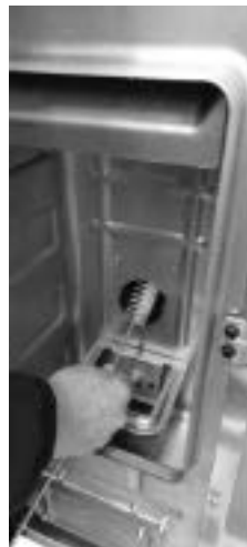
Fig. 41 - Rengöring med piprensare
