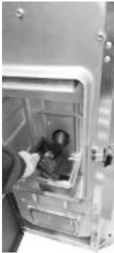
Fig. 38 - Borttagning av brännkoppen
