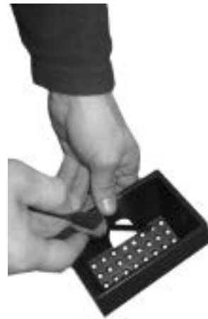
Fig. 39 - Rengöring av brännkoppen
