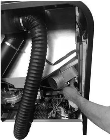
Fig. 35 - Skruva fast hölje + fläkt på kaminen
