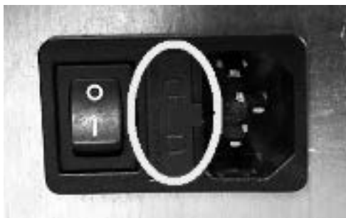
Fig. 73 - Lucka med säkringar som ska tas bort
