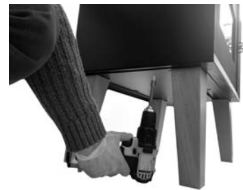
Fig. 19 - Fastsättning av kaminen
