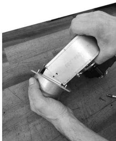
Fig. 30 - Sätt fast fläns + koppling på fläkten
