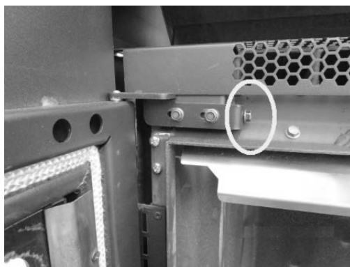
Fig. 24 - Justering av dörr
