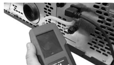
Fig. 51 - Digital tryckvaktanslutning At Mode och Quasimodo 3 Upp
