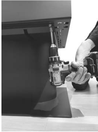
Fig. 16 - Fastsättning av sockel
