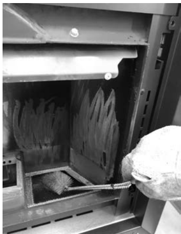
Fig. 68 - Rengör med en rörrengöringsborste
