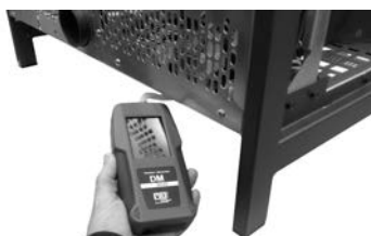
Fig. 50 - Anslutning av digital tryckvakt Frame 3
