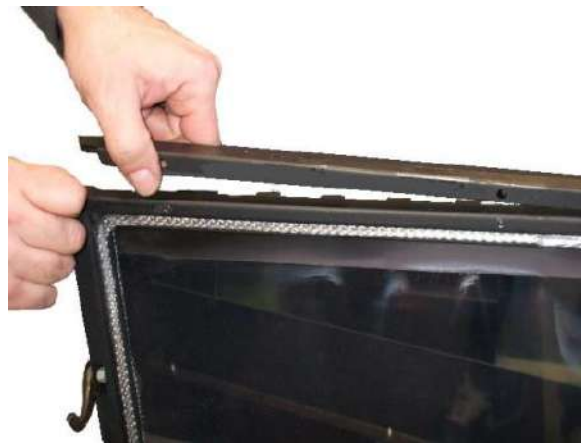
Fig. 117 - Door profiles removal
