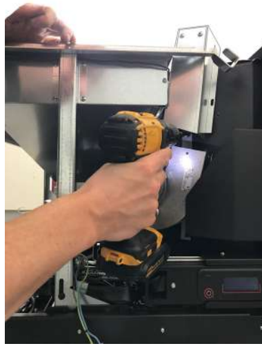
Fig. 45 - Secure the fan
