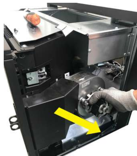
Fig. 99 - Remove the fan
