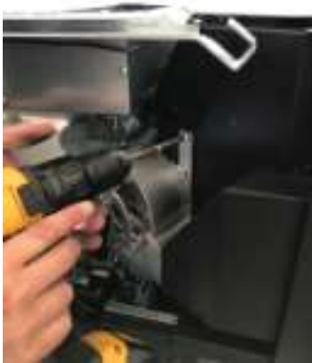
Fig. 38 - Remove the fan
