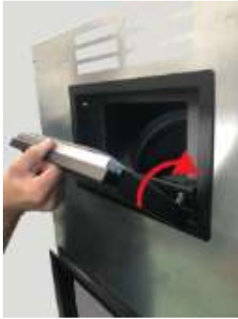
Fig. 72 - Insert the door in the trapdoor
