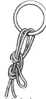
Dubbelt halvslag om egen part med dubbel lina.
