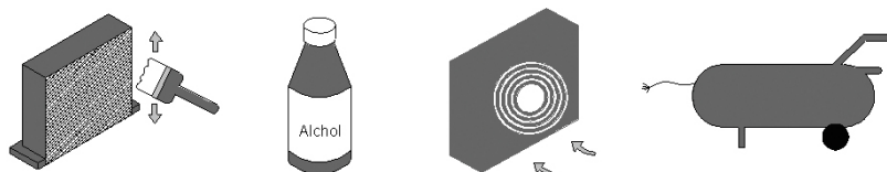
Figura 6 Pulizia del Condensatore
