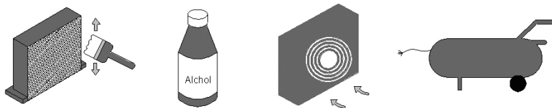
Figura 6 La limpieza del condensador
