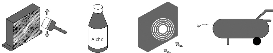
Figure 6 Nettoyage du condenseur
