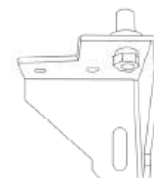
6. Den Scharnierstift in der anderen Seite montieren, aber nicht zuspannen.
