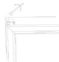
8. Utáhněte čep horního pantu.
