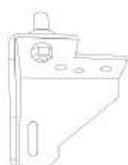
7. Dvignite vrata v pravi položaj na zgornjem tečaju.
