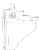
10. Monteer de onderste scharnierpen in het gedraaide onderscharnier.
