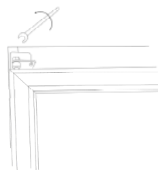
8. Draai de bovenste scharnierpen vast.
