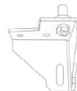
9. Démontez le pivot de la charnière au fond, et tourner la charnière 90 degrés.
