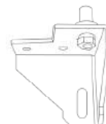
9. Wyjąć sworzeń zawiasu dolnego i obrócić zawias dolny o 90 stopni.
