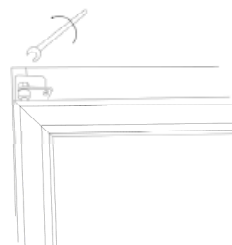
8. Den Stift vom oberen Scharnier spannen.
