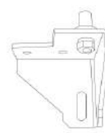
6. Zatič zgornjega tečaja vstavite na nasprotni strani, a ga ne zategnite.
