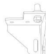
6. Illessze be a forgópánt csapját az ellenkező oldalon anélkül, hogy megszorítaná.
