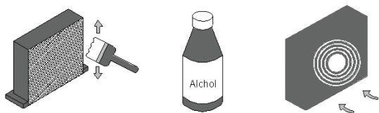
Fig. 6 Reinigung des Kondensators
