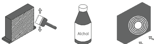
Figure 6 Nettoyage du condenseur
