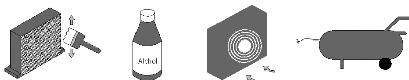
Figura 6 Pulizia del Condensatore
