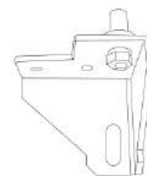
9. Távolítsa el az alsó forgópánt csapját, és fordítsa el 90 fokkal az alsó forgópántot.
