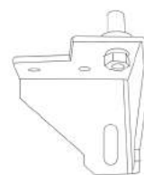
9. Démonter le pivot de la charnière au fond, et tourner la charnière 90 degrés.
