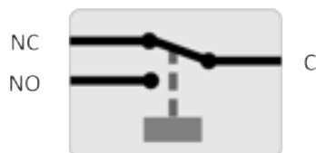
Intern drift av det programmerbara reläet
