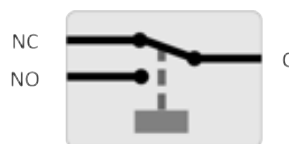
Reläkonfigurering (ej försett med ström).
