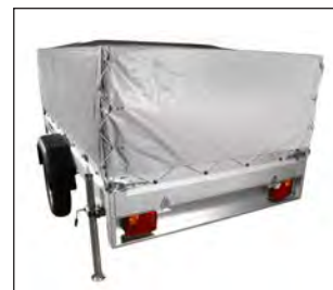
DK: 90643-ALT og 90644-ALT kan åbnes i både front og bag. DE: 90643-ALT und 90644-ALT können vorne und hinten geöffnet werden.
