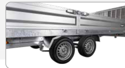
Paraboliska bladfjädrar och kompakthjul
