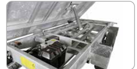
Hydraulcylinder, pump och batteri
