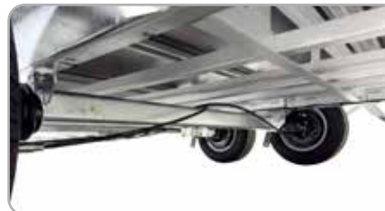
Underrede och axlar i hög hållfasthet
