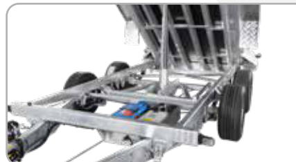
Kolv, pump och batteri
