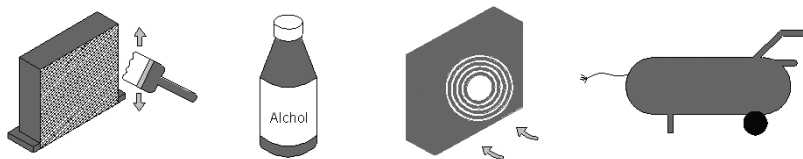
Figure 6 Pulizia Del Condensatore
