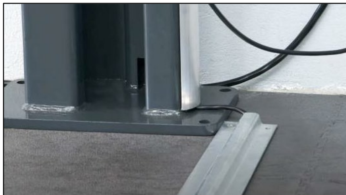
Illustration: Kabelkanal och överkörningsplatta
