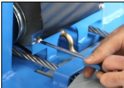
Bild: Montering av kedja och dörrstoppskydd
