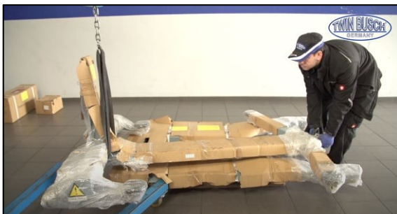
Illustration: Förflyttning av stödarmen med lyftbälte
