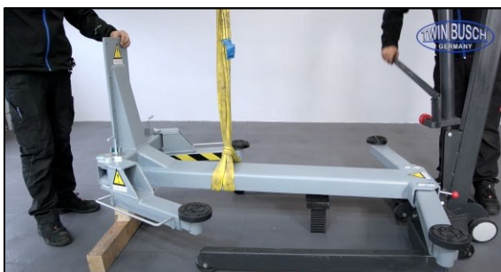
Illustration: Inriktning av stödarmsenheten
