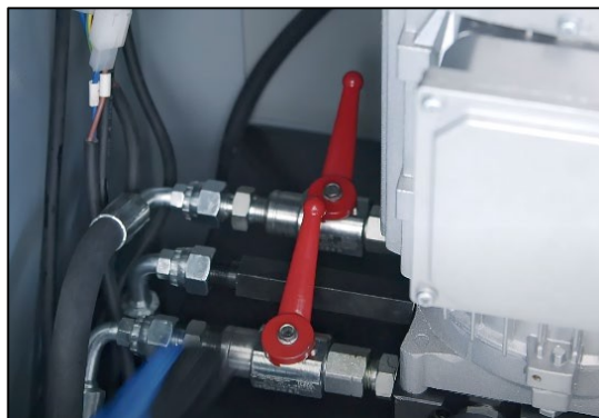
Illustration: Kulventiler i driftläge
