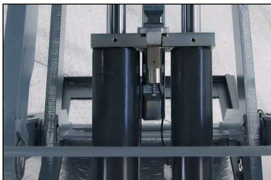
Illustration: Avlägsnande av låsmagneten
