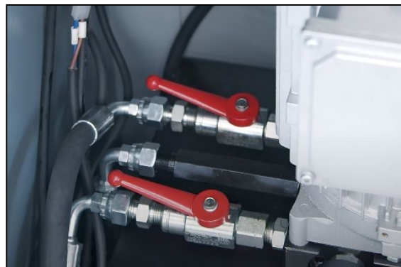
Illustration: Kulventiler i utjämningsläge
