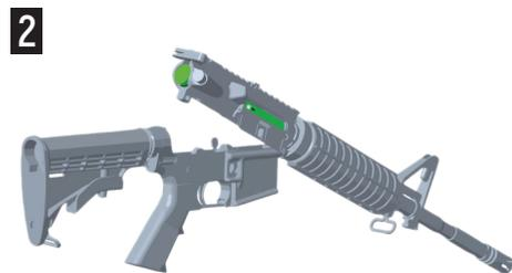
Insérer doucement le WLB 15 dans le récepteur jusqu'à ce qu'il se fixe.
