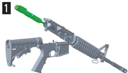
Retirez le groupe porte-boullons d'origine. Guidez le WLB15 dans la pointe laser du récepteur vers l'avant.
