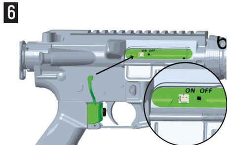
Kabel mit WLB 15 verbinden und Hauptschalter auf "ON" stellen.
