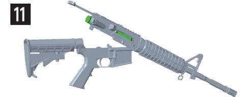
Gehäuseteile des Gewehrs trennen und abkippen. Ladehebel vorsichtig nach hinten ziehen und WLB 15 aus Gehäuse entfernen.
