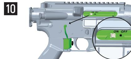
Hauptschalter auf "OFF" stellen. Kabel von WLB 15 entfernen. Gegenplatte von Abzugschalter entfernen.
