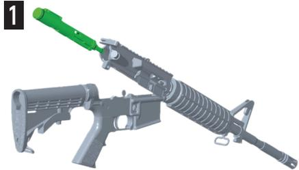
Originalen Verschluss ausbauen. WLB 15 mit der Spitze zuerst in das Patronenlager führen.
