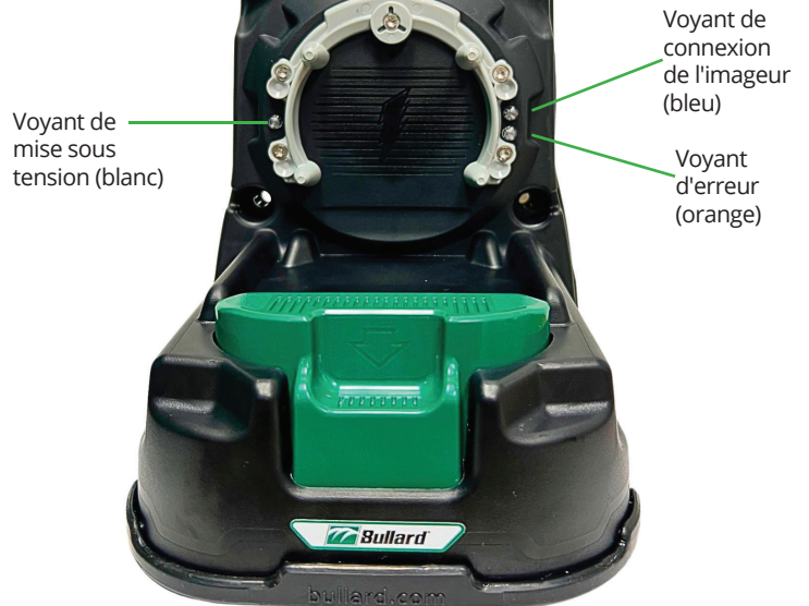
Figure 3 : Signification et position des voyants du chargeur sans fil de la série XT
