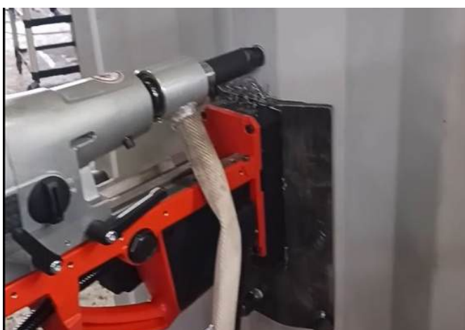
Den buede vakuumplade bruges som her - på en 20" ISO-container
