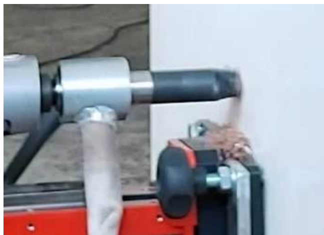
Den flade vakuumplade bruges som her - på en BD30 branddør
