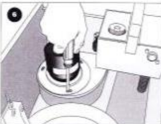
Motorn lossas från skåpan (3 skruvar) Fortsättning på nästa sida.
