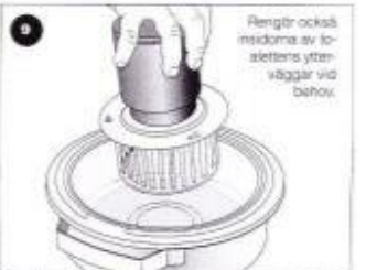
Sänk fläkthjulet ned i keret. Se till att det inte kommer vatten upp på motordelen.
