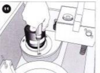
Fläktmotorfläkthjul och ledningar monteras tillbaka på plats i motsatt ordning. OBS! Skruvarna och bickarna måste lossas helt från fläkthuset och placeras efter att motorn är placerad för att bickarna ska komma på plats över glödspåren.
