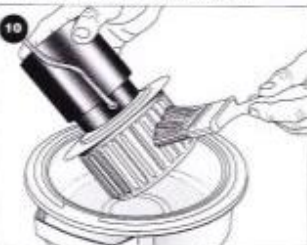
En hårdare borste kan användas för att rengöra fläkthjulet.
