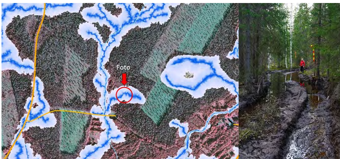
Bild 1. Markfuktighetskartan. Nytt planeringsverktyg för att undvika körskador från skogsmaskiner. Foto: Håkan Hjort, Niac Photo.
