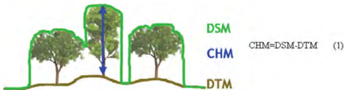
Figur 8. Förklaring av relationen mellan ytmodell (DSM), kronhöjdsmodell (CHM) och höjdmodell (DTM).
