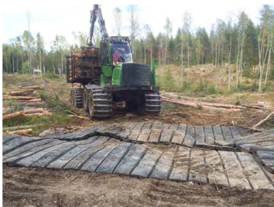
Sprängmattor kan användas både för att skydda marken (t.v.) och för att förstärka broar, samt dess på- och avfarter (t.h.).
