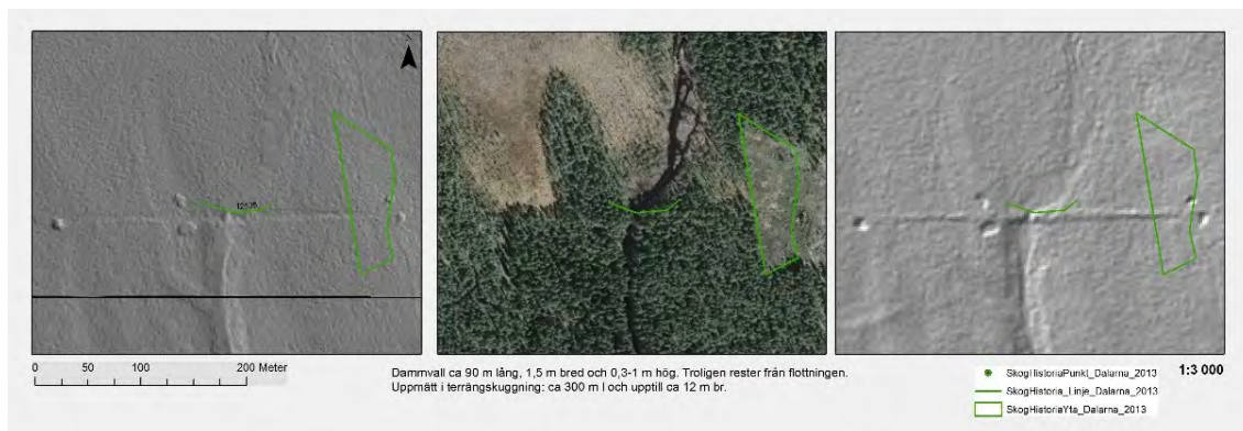
Figur 4. Jämförelse av hur väl en dammvall framträder i terrängskuggning av olika upplösning.
