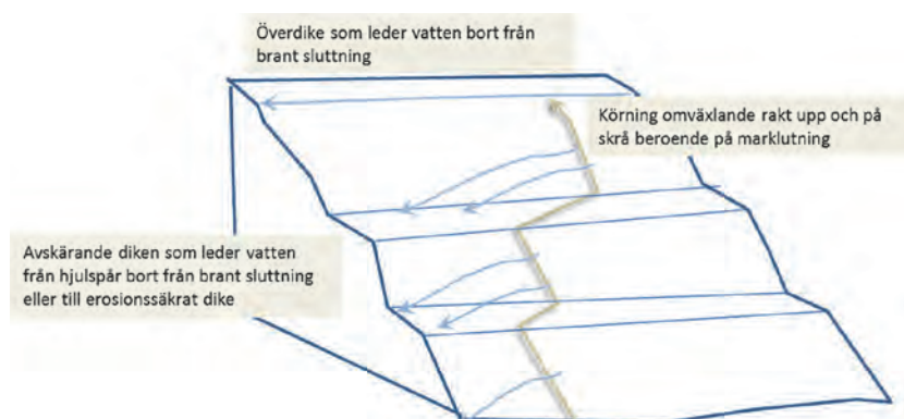
Figur 17. Exempel på dragning av bas- eller stickväg längs en sluttning samt hur vatten i anslutning till vägsystemen kan hanteras genom att ledas bort via överdiken och avskärningsdiken. Illustration: K. Lundström.
