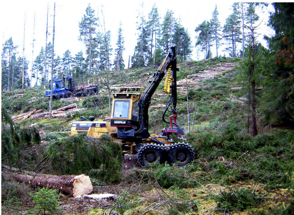
Figur 15. Körning med skotare och skördare under avverkning av slänt. Bas- och stickvägar har lagts upp- och ned längs slänten. Foto: H. Stahre
