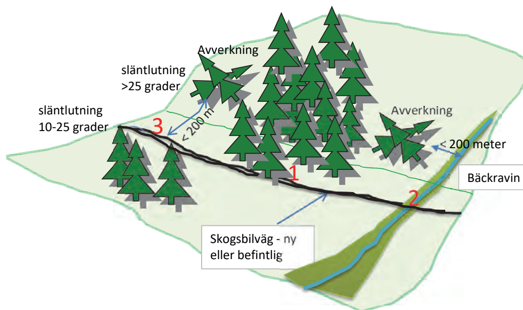
Figur 24. Illustration av de specifika förhållanden som redogörs för i föreliggande rapport utöver vad som anges i Skogsstyrelsens anvisning "Anvisning för projektering och byggande av skogsbilvägar klass 3 och 4" (Gunnarsson, m fl., 2011). Punkt 1 rör vägar på skrå inom slänter med en lutning av 10-18 grader, punkt 2 rör vägar över raviner och där avverkning planeras inom 200 meter från ravinen och punkt 3 rör vägar där avverkning planeras närmare än 200 meter ovan vägen i mycket kraftigt lutande terräng (över 25 grader). Illustration, K. Lundström.
