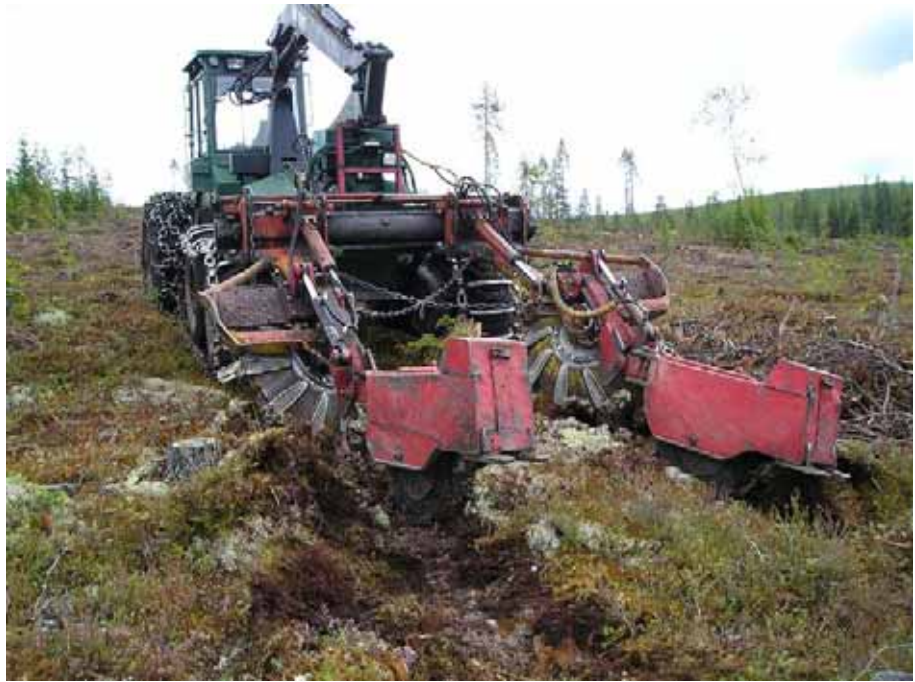
Harv-sådd - Kontinuerlig radsådd med odriven harv.
