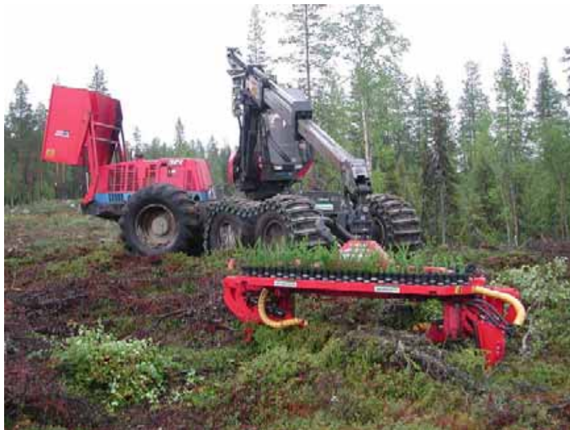
Eco-Planter - Kranspetsmonterat planteringsaggregat på skördare.
