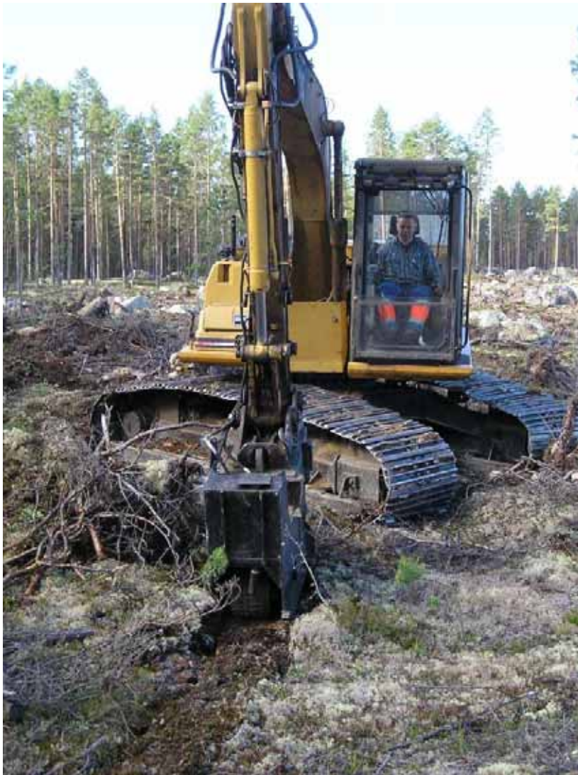
Eco-Seedplanter - Kranspetsmonterat såddaggregat på grävmaskin.
