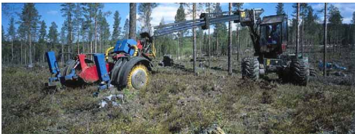
Humax 24 - Kranspetsmonterat såddaggregat på skördare.
