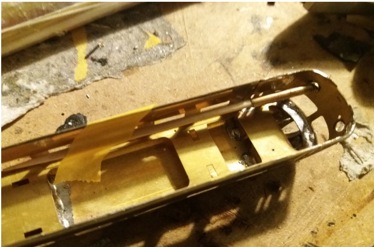
Fixering av frontstrålkastarhus innan lödning.
