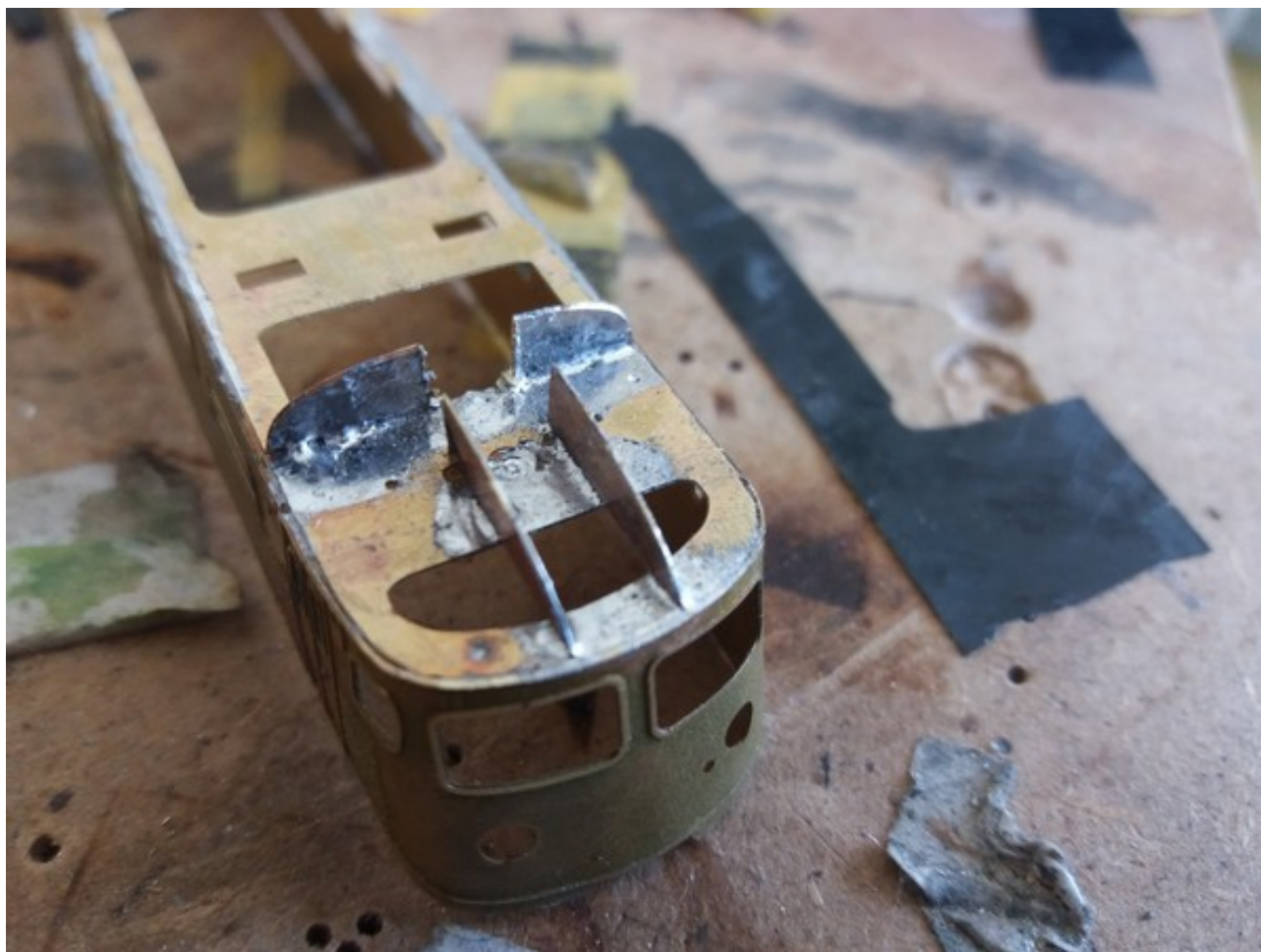
Takspryglar på ändvagn, med ursågning för kommande installation av belysning.
