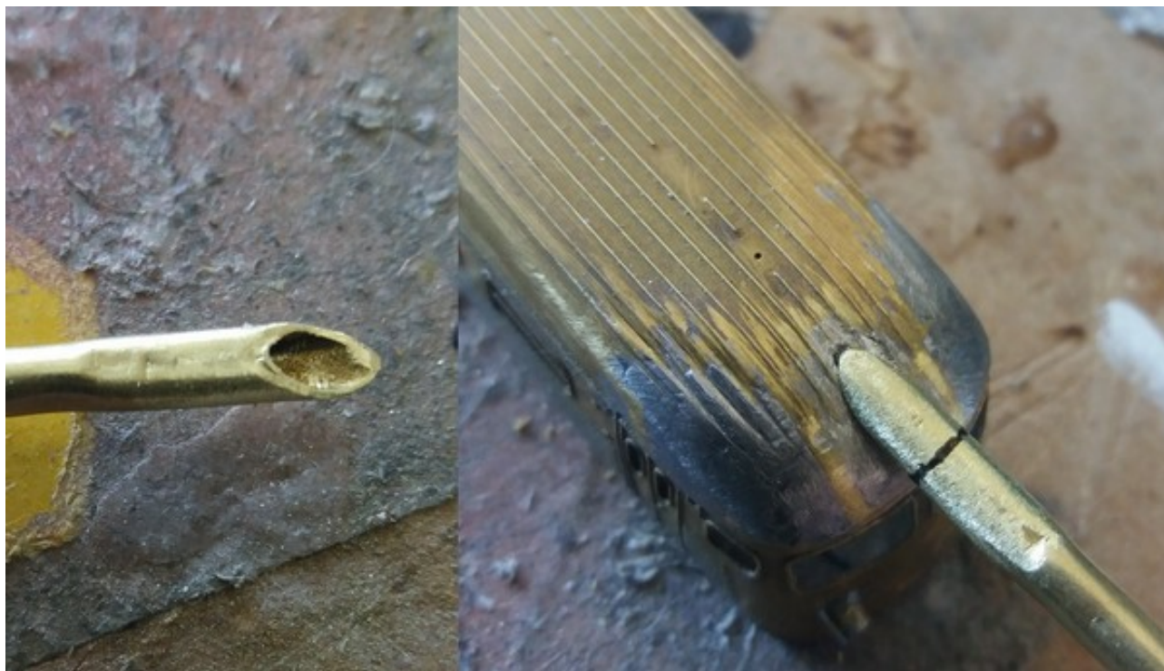
Bygge och montering av toppstrålkastarhus.
