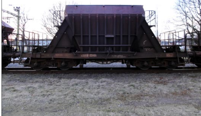
Littera Faoos-x byggdes av AGEVE 1977 i 105 exemplar för malmtransporter till Domnarvret. Ursprungligen var de öppna med litt. Uads 751 och senare Faoos-t 751. De lastar 28,5 m 3 , egenvikt 24,8 ton och längd över buffertar 12 000 mm. Vagnen finns inte i modell. Ritning finns på sidan 8 här: www.mrw1.se/pdf_filer/637_8x.pdf
