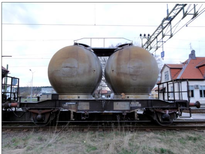
Littera Faoos-x byggdes av AGEVE 1977 i 105 exemplar för malmtransporter till Domnarvret. Ursprungligen var de öppna med litt. Uads 751 och senare Faoos-t 751. De lastar 28,5 m 3 , egenvikt 24,8 ton och längd över buffertar 12 000 mm. Vagnen finns inte i modell. Ritning finns på sidan 8 här: www.mrw1.se/pdf_filer/637_8x.pdf
