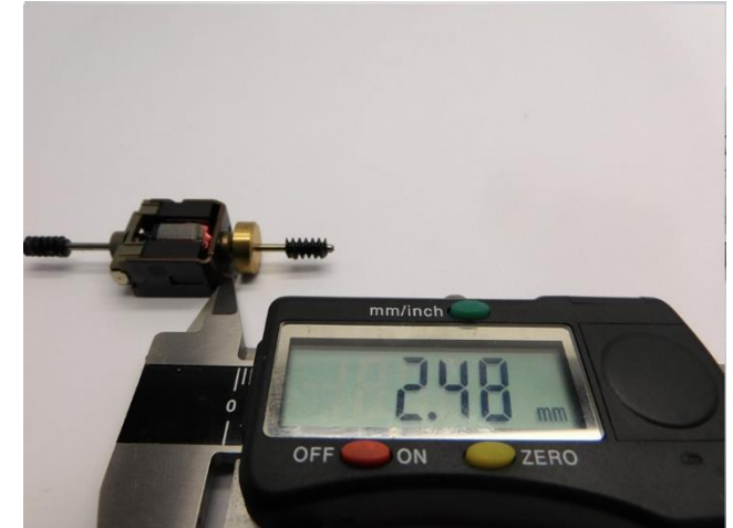
Maße prüfen Check dimensions Controleer de maatvoering
