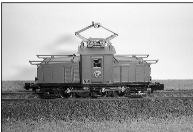
Arnolddrivningen med sin kåpa modifierad till motorhållare.
