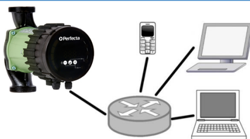
Figur 4: anslutning till ett nätverk via switch/router
