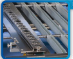
Marginatore con cinghia obliqua e squadra con biglie Side lay register table with an angled in feed belt and roller table
