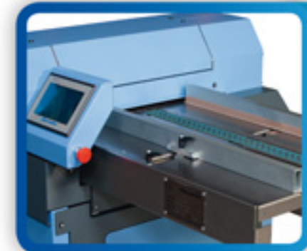
Entrata macchina con particolare "vacuum belt" Vacuum belt feeder
