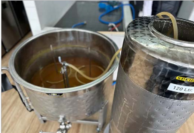
Pumping process for Braumeister 100 litres.
